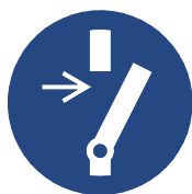
66947 – Revisieklep/revisiedeur: „Voor werkzaamheden spanningsvrij maken“, „Waarschuwing voor bekneling“
